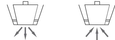
1) 此为单向动作微波传感器，专门检测接近信号，而对离去信号予以屏蔽；非常适合于快速门等应用场合，可有效避免门体自感及非接近目标的误动作开启等现象。
