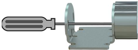
①通过吸片固定支架的定位孔，若发现磁力锁体与吸体不配对时，因根据现场实际安装方向拧出吸片，装到固定架的另一个侧面，使之与锁体配对。
