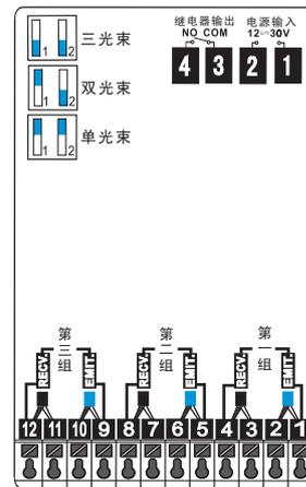
**!** 注：单光束必须接在第一组处；双光束必须接在第一组和第二组。
