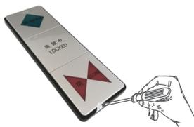
注：打开面盖前用一张小纸片将其垫上，以免盖面划伤，影响美观。再用扁头形小螺丝刀放在纸片缝处将面盖往上轻微撬，面盖就被打开了。
