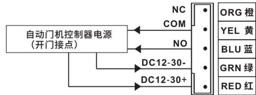
无线接收器控制自动门机接线图
